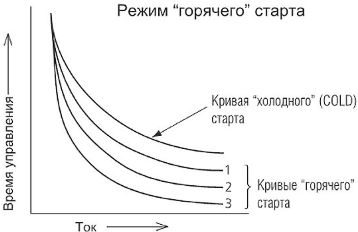
1. Когда реле управления током включается при 50% действующего тока, время управления в режиме Hot составляет примерно 80% от значения в режиме COLD.
